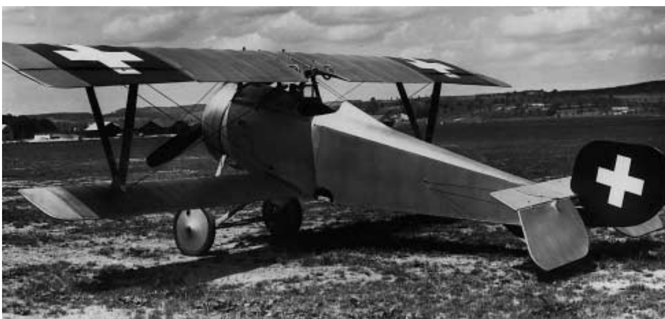
Die Nieuport 23 C-1 hat eine Spannweite von 8.16 m und eine Länge von 5.80 m, ihre Höchstgeschwindigkeit beträgt rund 170 km/h. Das Foto wurde am 1. Mai 1918 in Dübendorf aufgenommen.
