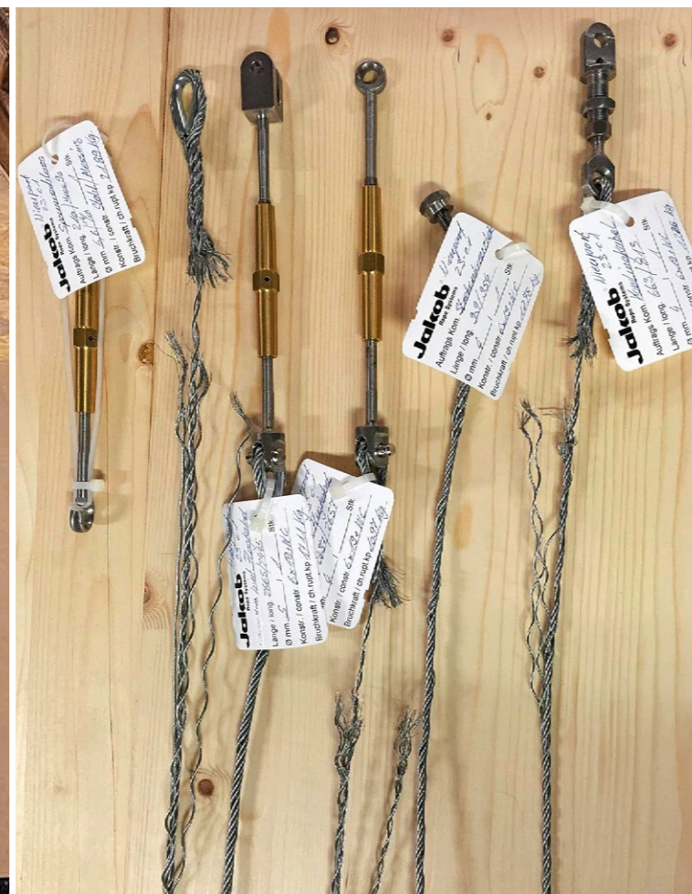
Bewiesen belastbar Reisstest der gespleisssten Kabel und Spanndrähte.
