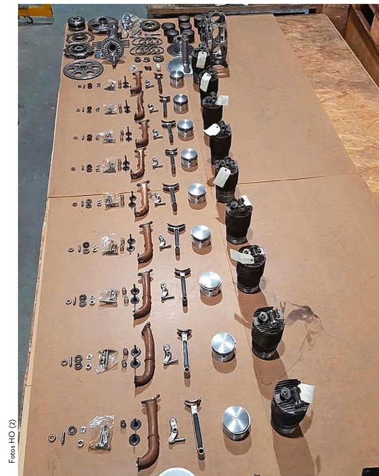
Inventar Einer der Le-Rhone-Flugzeugmotoren in Einzelteile zerlegt.
